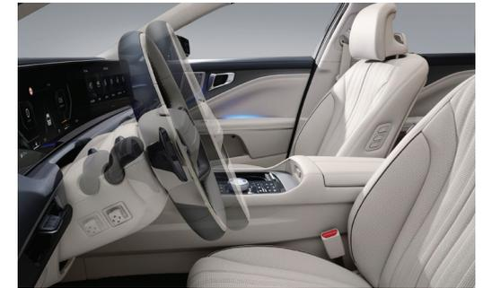
Электрорегулировка руля по высоте и углу наклона
