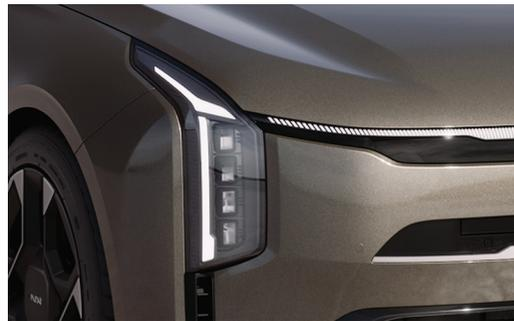
Светодиодные передние фары с системой матричных световых элементов
